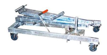
**CARACTERISTIQUES:** De nombreux travaux nécessitent le soulèvement, le maintien ou l'alignement de lourdes charges qui sont exécutés sur les chantiers et dans des ateliers. Cet élévateur à bras mobile permet de réduire les charges corporelles. L'élévateur à bras est utilisé pour soulever ou abaisser des poutres en acier lors de travaux de transformation ou de réparation.
